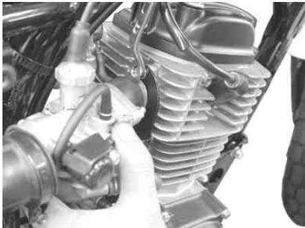
取り付けしたキット内のフィードパイプステー部に、エキゾーストパイプを動かし、エキゾーストパイプのステー部を合わせ、ボルトを仮締めします。
