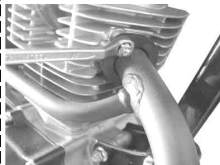
インレットパイプ部に取り付けているフィードパイプステーをキット内のステーに取り付け替えます。
