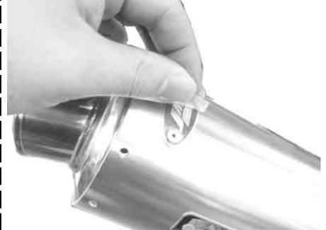
マフラーに付着した汚れをよく拭きとります。エンジンを始動させ、排気漏れの有無を確認します。
