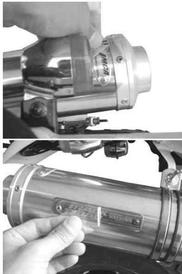
サイレンサー部のネームプレート及びJMC Aプレートの保護フィルムを剥がします。
