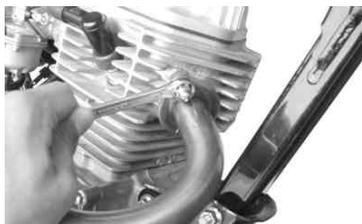
シリンダーヘッドEXポート部のフランジナットを均等に規定トルクまで締め付けます。
