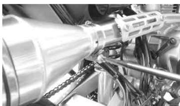
サイレンサージョイント部のバンドを締め付けます。
