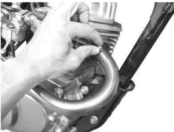
エキゾーストパイプをシリンダーヘッドエキゾースト側に差し込みキット内のフランジナットを用いて仮締めします。
