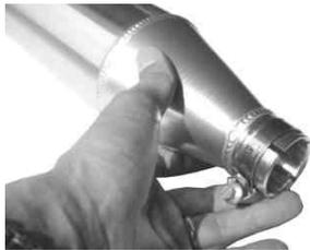
サイレンサーCOMP のジョイント部にバンドを取り付け、エキゾーストパイプにサイレンサーCOMP をストッパーに当たるまで差し込みます。
