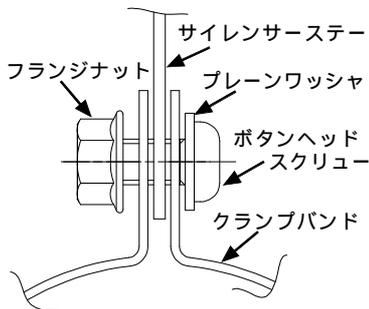
クランプバンドにバンドラバーを巻き付け、サイレンサー部に通し、サイレンサーステーにプレーンワッシャ、ボタンヘッドスクリュー、フランジナットを用いてクランプバンドに、サイレンサーステーをはさむ様に、取り付け、仮締めします。
