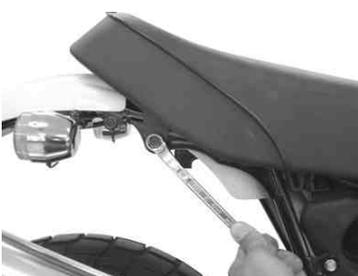
右側のシートを取り付けている六角フランジボルトを取り外します。
