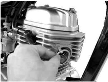
2. エキゾーストパイプComp.を、シリンダーのエキゾースト側に差し込み、純正ナットで仮止めします。
