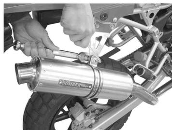
8. サイレンサーを固定したら、タンデムステップや車体などに、マフラー及びサイレンサーが干渉しない事を確認して下さい。
