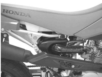
3. EXパイプ部のナット2個を取り外します。
