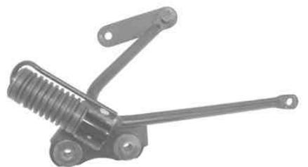
フレームとステー右との間に、キット内のプレーンワッシャ8mmを挟み、取り外したピリオンステップのボルトを用いて取り付け、仮締めします。
