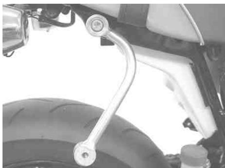
キットのエキゾーストパイプCOMP.を取り付け、STDナットを用いて仮締めします。
