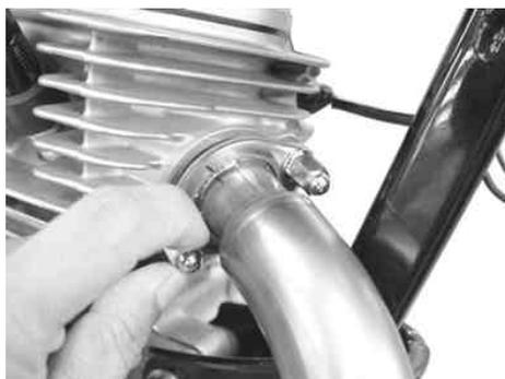
エキゾーストパイプジョイント部に耐熱ガスケット材を薄く塗布します。
