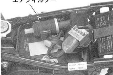
コネクティングチューブのホースジョイントからクランクケースブリザーホースの接続を外します。
