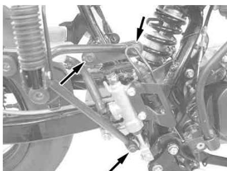
左側も同様に、ピリオンステップ上側にステー左、ブレンワッシャ、ピリオンステップ下側にカラー 2 (5mm) をピリオンステップボルト及びキット内のフランジボルト 8 x 2 5 を用いて取り付けます。
