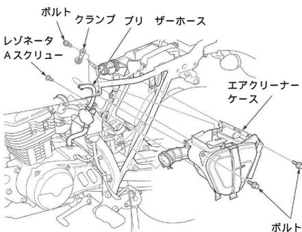
エアクリーナーケースを取り外します。レゾネータBからホースの接続を外します。レゾネータBマウントスクリーンを取り外します。
