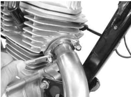
サイレンサースターのソケットキャップスクリュー 8 x 20 及び左側のシート取り付けボルトを規定トルクまで締め付けます。
