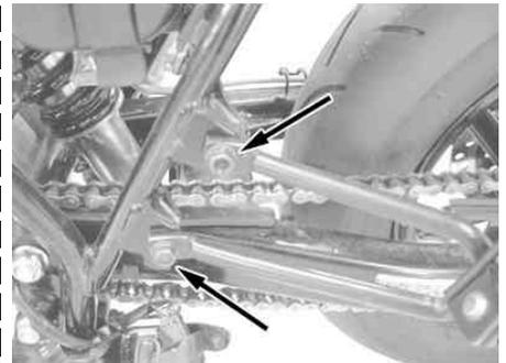
右ピリオンステップの上側にキット内のステー右を、取り外したピリオンステップのボルトを用いて取り付け、仮締めします。
