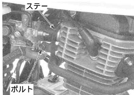
二次空気供給ホース及び負圧チューブを取り外します。
