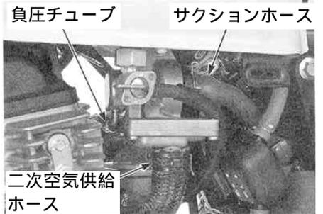
ボルト 2 本を取り外し、二次空気供給制御バルブを取り外します。
