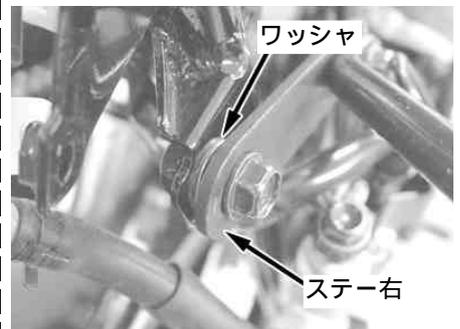
ピリオンステップ下側にキット内のカラー 1 (7mm) をフレームとの間に入れ、キット内のフランジボルト 8 x 3 5 を用いて取り付けます。
