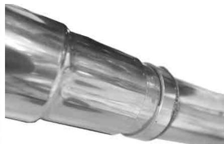
クランプバンドにバンドラバーを巻き付け、サイレンサー部に通し、サイレンサーステーにノーマルのフランジボルト 8 x 2 5 を用いてクランプバンドに、サイレンサーを挟む様に、取り付け、仮締めします。
