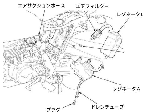
取り外しと逆手順でエアクリーナーケースを取り付けます。マフラー取り付け要領に従い、マフラーを取り付けます。
