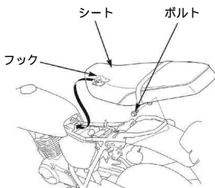
右側のシート取り付けボルトの位置にキット内のサイレンサーステーを、キット内のソケットキャップスクリュー 8 x 2 0 を用いて取り付けます。
