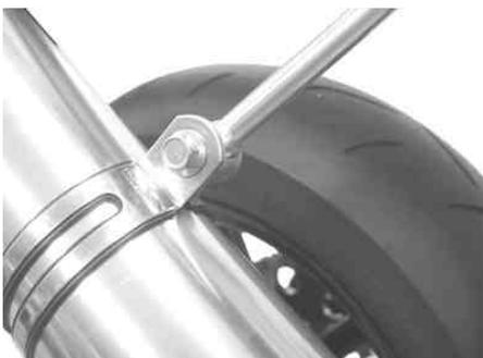
キット内のジョイントスプリングをエキゾーストパイプとマフラーパイプのスプリングフックに取り付けます。
