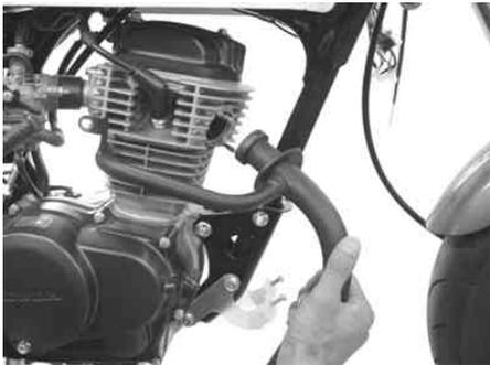
キャブレターインシュレーターのバキュームホースが取り付けいていたユニオンに、キット同梱のインシュレーターキャップをクリップを用いて取り付けます。
