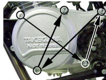
8. スプロケットガードをボタンヘッドスクリュー(5×12)で写真のように取り付け、ボタンヘッドスクリューを締め付けます。
