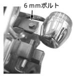
3. キット内のバルブを ウインカーCOMP. に取り付けます。 (レンズビスを締め過ぎた場合、レンズが破損しますので注意して下 さい。)
