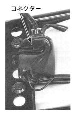
2. ウインカー取り付け部の6 mmボルトを緩めて、左右のリアウイン カーをそれぞれ取り外します。
