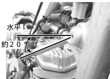
ステアリングダンパー本体にダンパーホルダーを入れ、フレームステーに取り付ける。ステアリングダンパーを指定位置にあわせ ボタンヘッドスクリューで締め付ける。
