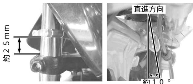
ステアリングダンパーキットに付属のロッドエンドと六角ナットをフレームステーに取り付け、指定寸法で仮締める。フレームステーを指定位置でフレームに取り付け Uボルト、フランジロックナットを使用し仮締める。
