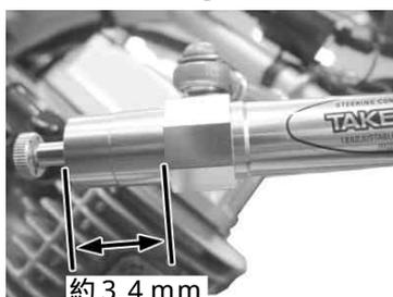
ステアリングダンパー本体のロッドエンドを、ダンパーステーに取り付け ボタンヘッドスクリューで締め付ける。
