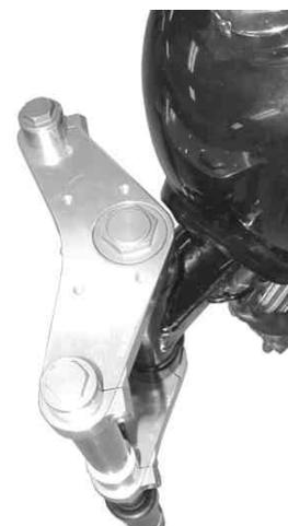
18. ステアリングステムの割り締めボルトを緩め、インナーチューブの突き出し量を左右同じになるように調節します。
