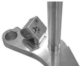
11. ステアリングステムのボトムコーンレースをポンチドライバーやタガネ等を取り外し、ダストシール、ダストシールワッシャを取り外します。ジュラルミンステムシャフトにダストシールワッシャ、ダストシール、ボトムコーンレースをそれぞれ取り付けます。
