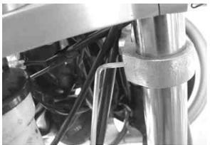
23. ホーンを取り付けます。(写真はステアリングシステムに取り付けた場合です。)ステアリングシステムに取り付ける場合、写真の様に折り曲げ、フランジボルト(6×15)で取り付け、締め付けます。
