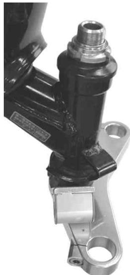
14. ステアリングステムにフロントフォークのアクスルホルダーにブレーキの回り止めが付いている方を進行方向に向かって右側に通し、ステアリングステム割り締めボルト(8×20)を仮り締めします。
