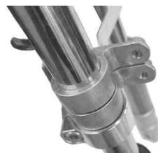
17. ワイヤハーネス等の取り回しがノーマルと同じになるようにしながらトップブリッジをフロントフォークとステムシャフトに通し、ステムワッシャを入れてステムナットを指定トルクで締め付けます。
