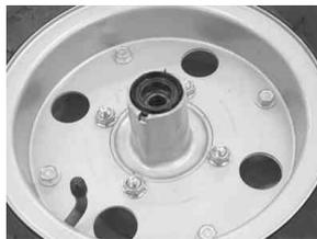
26. ブレーキシュー、フロントブレーキカムを弊社ブレーキパネルに付け替えます。弊社ブレーキアームをフランジボルト(6×25)でフロントブレーキカムに取り付けます。
