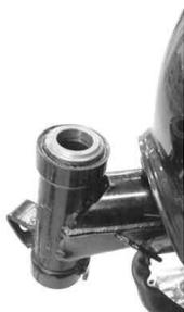
13. ステアリングステムをヘッドパイプに通し、トップスレッドは手でいっぱい締め付けます。左右に4、5回躍動させベアリングをなじませ、約1/8回転戻し、ガタが無く軽く動くことを確認して下さい。
