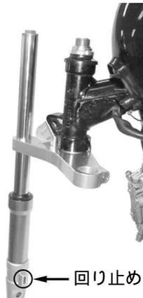
15. 左側を右側と同様に取り付けます。ボスの出が多い方を外側にして、組み付けて下さい。
