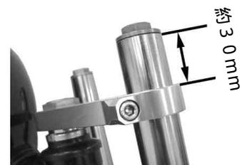
19. ステアリングステムの割り締めボルトを指定トルクで締め付けます。
