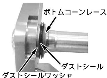
12. トップコーンレース及びボトムコーンレースにグリスを塗布し、ベアリングをステアリングステム、ヘッドパイプに取り付け、トップコーンレースをヘッドパイプに取り付けます。
