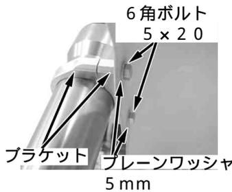
(06-01-0215) フロントフェンダー及びボルトをそのまま付け替えて下さい。ノーマルフロントフェンダーを使用し、ホーンをステアリングシステムに取り付ける場合、フロントフェンダーとステアリングシステムの間にはホーンを挟み、もう片側は1.5mm程の厚さのワッシャーを挟むようにして取り付け、フランジボルト(6×15)で締め付けます。
