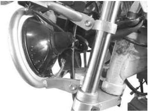
ヘッドライトガードの高さを調節し、ソケットセットスクリュー4本を締め付けます。
