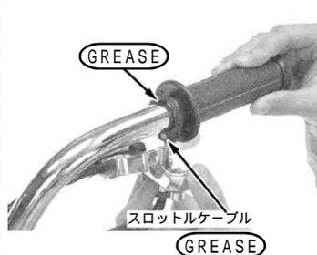
アッパー、ロアスロットルハウジングをセットし、スクリーンを取り付けます。前側のスクリーンを先に締め付けてから後側のスクリーンを規定トルクで締め付けます。
