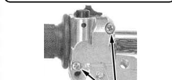
F I 車両の場合、ハウジングに突起があります。突起を加工し除去して頂くか、ハンドルバーに穴をあけ取り付けます。
