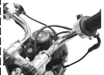
ハンドルホルダーのハンドルノブを再度確実に締め付けます。バックミラー、ワイヤーバンドを取り付けます。
