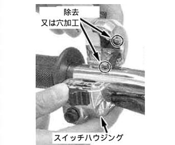
ケーブルの取り回しを調整します。ノーマルスロットルハウジングを使用する場合、スロットルケーブルがノーマルの配置ではケーブルに無理がかかる為、一旦ヘッドライトケースを外すかスロットルハウジングからスロットルケーブルを外し、取り回しを変更します。
