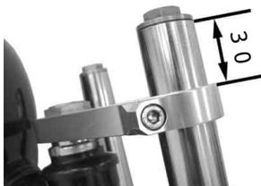
19. ステアリングシステムの割り締めボルトを指定トルクで締め付けます。
