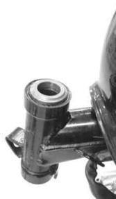
14. ステアリングシステムをヘッドパイプに通し、トップスレッドは手でいっぱい締め付けます。左右に4、5回躍動させベアリングをなじませ、約1/8回転戻し、ガタが無く軽く動くことを確認して下さい。
