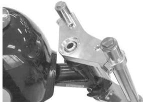
18. ステアリングシステムの割り締めボルトを緩め、インナーチューブの突き出し量が左右同じになるように調節します。ノーマルと同じキャスト角にするには約30mm突き出します。
