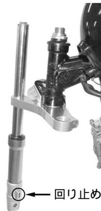
16. 左側を右側と同様に取り付けます。ボスの出が多い方を外側にして、組み付けて下さい。
