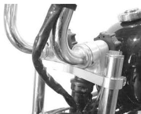
22. ホーンを取り付けます。(写真はステアリングシステムに取り付けた場合です。) ステアリングシステムに取り付ける場合、写真の様に折り曲げ、フランジボルト(6×15)で取り付け、締め付けます。
