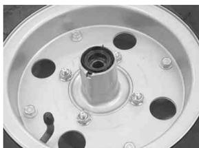
25. ブレーキシュー、フロントブレーキカムを弊社ブレーキパネルに付け替えます。弊社ブレーキアームをフランジボルト(6×25)でフロントブレーキカムに取り付けます。
