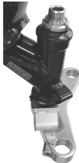
15. ステアリングシステムにフロントフォークのアクスルホルダーにブレーキの回り止めが付いている方を進行方向に向かって右側に通し、ステアリングシステム割り締めボルト(8×20)を仮り締めします。
