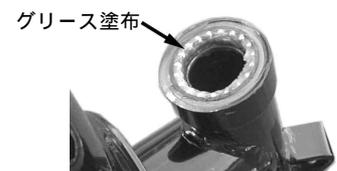
4. ステアリングシステムをステアリングヘッドに取り付けトップコーンレース、トップスレッドを取り付け、トップスレッドを手で一杯に締め付けます。
