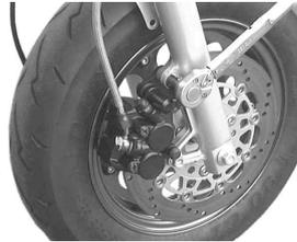
12. フロントフェンダーステーとボトムケースの間にカラーを入れ、ボタンヘッドスクリュー6×15で取り付け、スクリューを指定トルクで締め付けます。
