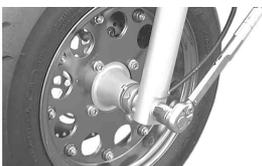
11. フロントフォークにキャリバーを取り付け、ボルトを指定トルクで締め付けます。
