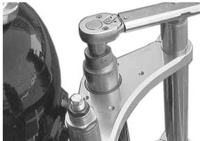
8. トップブリッジ割り締めボルトを指定トルクで締め付けます。
