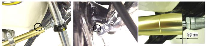
15. ダンパーステーのキャブスクリーを、指定トルクで締め付け
