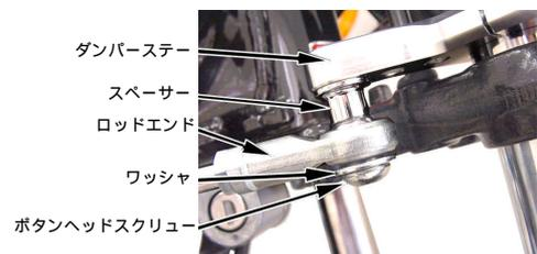
14. ステアリングを左右一杯まで切った状態で、ステアリングダン
