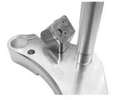
4 . ステアリングステムのボトムコーンレース をポンチドライバーやタガネ等で取り外し、 ダストシール、ダストシールワッシャを取 リ外します。 ステアリングステムCOM P にダストシールワッシャ、ダストシール、 ボトムコーンレースをそれぞれ取り付けま 分塗布し、スチールボールを取り付けます。 スチールボールは取り付け前に洗浄し、ゴミ 等を付けないようにして下さい。
