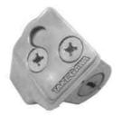
3. ステアリングロックブラケットを ソ ケットキャップスクリューで ステアリン グステムCOMP.に取り付けます。
