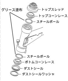
6. ステアリングステムをステアリングヘッド に取り付けトップコーンレース、トップス レッドを取り付け、トップスレッドを手で一 杯に締め付けます。
