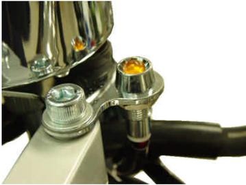
2. インジケータランプのコードをヘッドライトケース内に取り回し、サブハーネスに接続します。
