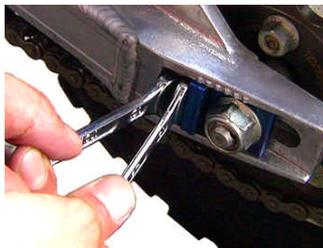
(8) フランジナットを締め付け (7) 六角ボルトをロックします。
