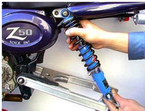
(1) スイングアームCOMP をフレームに合わせ、STDのピボットシャフトを通しフレームに取り付けSTDナットで仮締めします。
