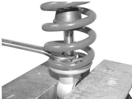
5. バイスよりショックを取り外し、ショックのアイを緩める方向に回して、ダンパーロッドより取り外します。
