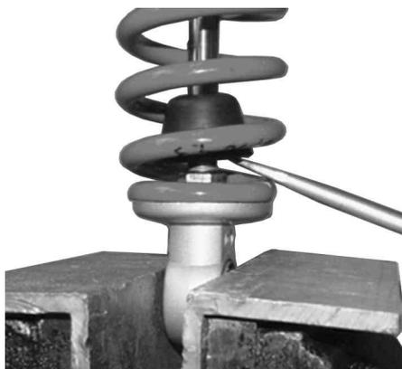
4. パンブラバーにカバーされていたナットを、スプリングの隙間からスパナで緩めます。
