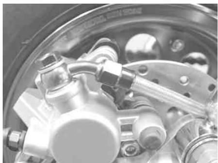
マスターシリンダーに2.5°パンジョーをシーリングワッシャーで挟む様、パンジョーボルトで仮締めします。
