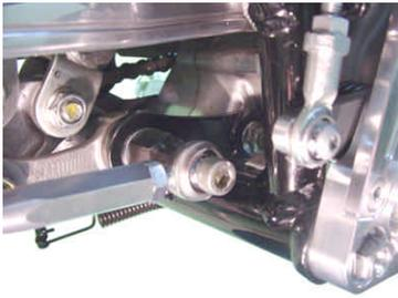
13. ドライブチェーンを調整し、リアアスルナットを指定トルクで締め付けます。
