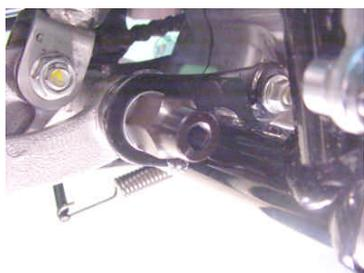
6. NSR50/80（以下NSR）用ホンダ純正リヤキャリパーASSY. からブレーキキャリパーを取り外し、ブラケットのボルトピンとブーツをKIT内の リヤキャリパーブラケットCOMP. に付け替えます。
