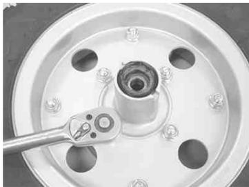
4. フロントホイールのエアバルブ側が、フロントホイールハブASSYのディスク側と逆になる様に、フロントホイールハブASSYをフランジキャップスクリューM8×2.0にて仮締めして下さい。
