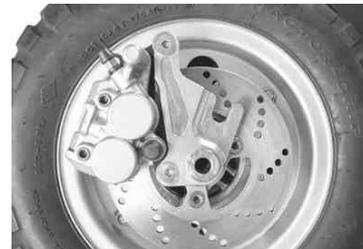
8. フロントフォークの凸部にキャリパーブラケットの凹部を合わせ、フロントホイール、スピードメーターギヤBOX、カラーの順で取り付け、アクスルシャフトを通し、アクスルナットを規定トルクで締め付け、固定して下さい。
