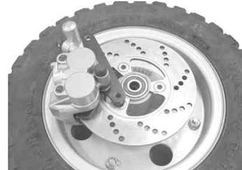
7. キャリパーをフラットヘッドキャップスクリュー(8×1.6)でキャリパーブラケットに取付け、締め付けます。
