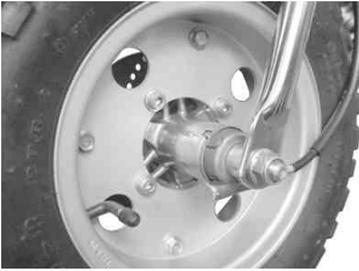
10. 別売りステンレスメッシュホースをキャリアまで取り回し、曲がっているバンジョーを、2枚のシーリングワッシャで挟むようにしてバンジョーボルトにてキャリアに取り付け、固定して下さい。
