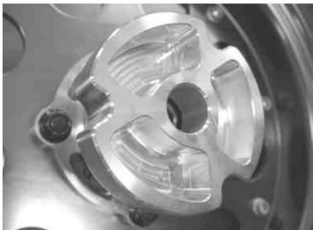
ホイールハブASSYとダンパーハブをホイールに挟むように取り付け、付属のロックナットで仮締めします。
