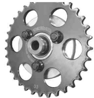
リテーナーCOMP.にドリブンスプロケットを付属のロックナットで規定トルクまで締め付け、カラーを取り付けます。
