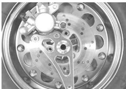
キャリパーをソケットキャップスクリュー(M8 x 12)でキャリパーブラケットに取り付け、規定トルクで締め付けます。
