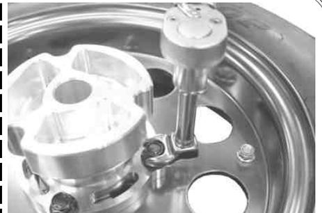
仮締めしていたロックナットを規定トルクで締め付けます。
