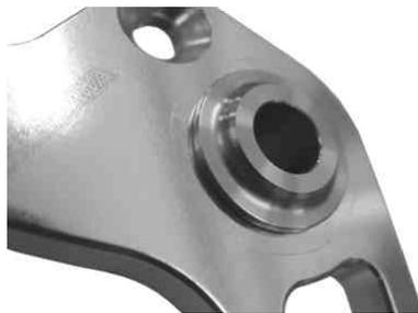
キャリパーブラケットのスリーブを付属のスリーブと付け替えます。
