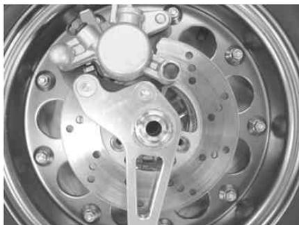
キャリパーをキャリパーブラケットにフラットヘッドスクリューで取り付け、規定トルクで締め付けます。
