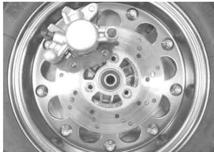
ディスクローターにキャリパーを取り付けます。ディスクローターを取り付けます。
