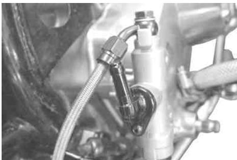
リヤブレーキホースCOMP.をバンジョー部にシーリングワッシャーで挟む様バンジョーボルトを用いてマスターシリンダーとリヤキャリアASSY.に取り付けボルトを規定トルクで締め付けます。
