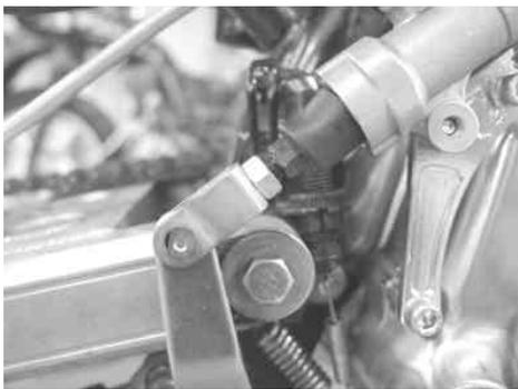
マスターシリンダーのプッシュロッドを回転させブレーキペダルの位置を調整し、六角ナットを締め付けロックします。
