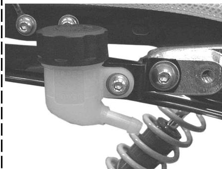
オイルカップCOMP.にリザーバタンクステアをブレンワッシャ、ボタンヘッドスクリューを用いて取り付けます。
