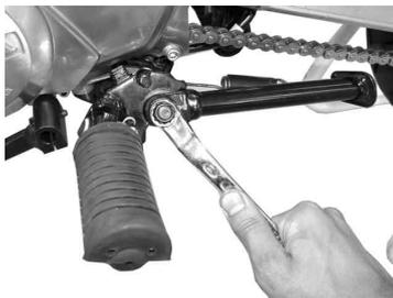
(8) ステップバーCOMPをクランクケースに固定しているボルトワッシャ8mm、4本を緩めステップバーCOMPを取り外します。
