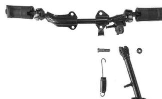
△注意：サイドスタンドスプリングの取り外し作業の時は、スプリングフック等の工具を使用し、注意しながら作業をして下さい。
