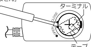
**テープで電池の回転抑止処理をして下さい。**
