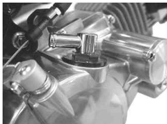
3. 以下の図を参考にホースを接続します。エアクリーナー側のホースはリアキャリア側へ通し、接続します。
