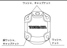
ストレートユニオン、 シーリングワッシャ を シリンダーヘッドカバーに規定トルクで締 め付けます。
