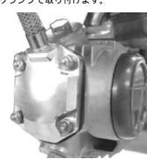
ブレードホースを適当な長さにカットし、 キャッチタンク等へ接続します。 フロントフェンダーを取り付けます。
