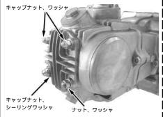
シリンダーヘッドカバーガスケット、 リンダーヘッドカバーを取り付けます。
