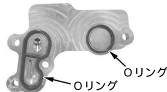
4. シリンダーヘッドにクーラーユニットを取り付けます。ソケットキャップスクリューを指定トルクで締め付けます。
