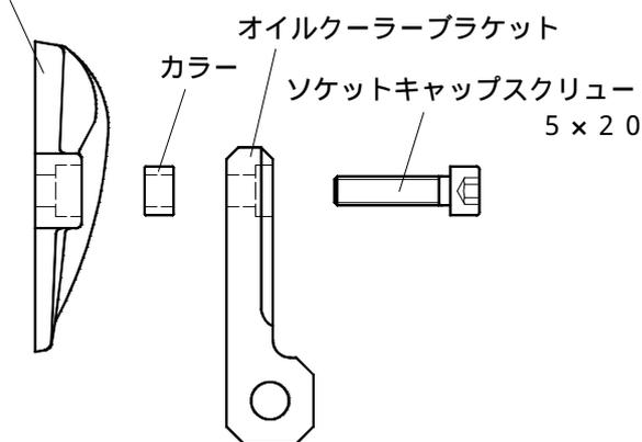
4. オイルクーラーステーにクッションラバーを取り付け、クッションラバーにカラーを取り付けます。
