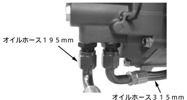
9. オイルホースが他の部分に著しく干渉しない様にオイルクーラーに取り付けます。オイルホースを乗車状態から見て右側のホースをオイルクーラー右側へ、左側のホースをオイルクーラー左側へそれぞれ取り付けます。取り回しが決まればオイルホースフィッティングを規定トルクで締め付けます。
