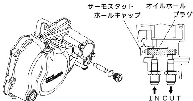
11. エンジンオイルを80cc程度追加し、エンジンを始動します。各部分からのオイル漏れの有無を確認し終わったらエンジンを止め、約1分後にクラッチケースカバーのオイルポッドウインドでオイルの量を確認し、少ない場合は必ず補充して下さい。
