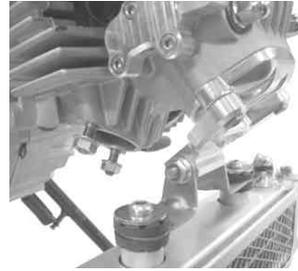
7. クラッチカバーのオイルプラグボルトを取り外し、アダプターM10にシーリングワッシャ10mmを通し、アダプターを取り付けます。
