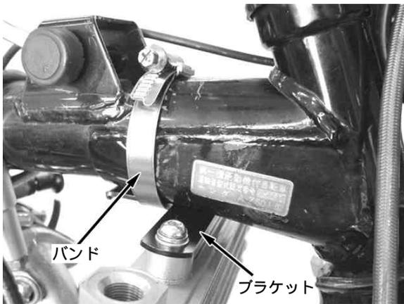
8. オイルクーラーブラケットにオイルクーラーCOMP.をボタンヘッドスクリュー(6×10)、スプリングワッシャ(6mm)とブレンワッシャ(6mm)で取り付けます。(この時、ワイヤーハーネスがオイルクーラーブラケットとオイルクーラーの間を通るようにして下さい。)
