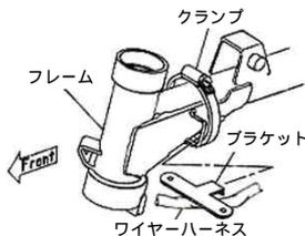
4. ボタンヘッドスクリュー6×10にスプリングワッシャ、ワッシャの順で通しオイルクーラーCOMP.を取り付けます。オイルクーラーCOMP.部分が前から見て水平で、横から見て垂直になっていることを確認します。歪んでいる場合は、オイルクーラー本体を持ってゆっくりと修正して下さい。
