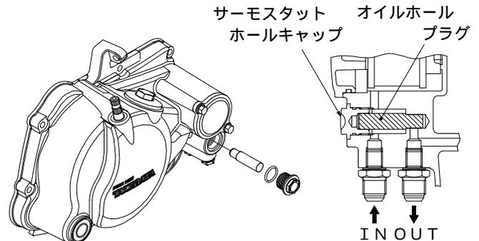
13. エンジンオイルをオイルクーラーのF I N Gが3段であれば40cc程度、4段であれば60cc程度追加し、エンジンを始動します。各部分からのオイル漏れの有無を確認し終えたらエンジンを止め、約1分後にクラッチケースカバーのオイルポッドウインドでオイルの量を確認し、少ない場合は必ず補充して下さい。
