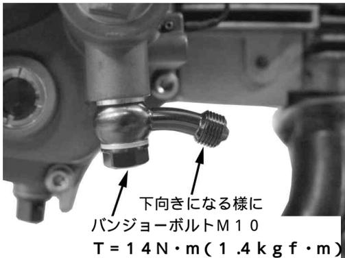
8. オイルクーラーバンジョーM10をシーリングワッシャ14mm2枚で挟み、オイルクーラーにバンジョーボルトM12で仮締めします。シーリングワッシャが凹部から外れた状態で締め付けた場合、オイル漏れの原因になります。
