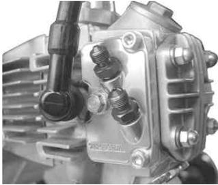
4. オイルクーラーブラケットにクッションラバーを取り付け、クッションラバーにカラーを取り付けます。
