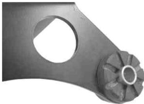
5. ボタンヘッドソケットキャップスクリュー（6×20）を用いてオイルクーラーブラケットにオイルクーラーCOMP.を取り付け、締め付けます。
