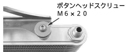
7. オイルクーラーステーをキット付属のUボルトとフランジフクロナットを使用し、写真を参考にしフレームを挟み込む様に取り付けます。
