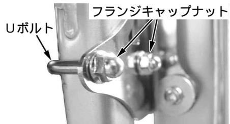
フレームの溶接跡に接触しないように取り付けを行って下さい。
