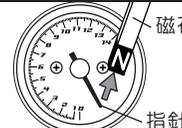
磁石を右図のようにゆっくりと移動させ、指針を「0」点まで戻す。強い磁石が無い場合、車両フライホイールを使用しても戻ります。
