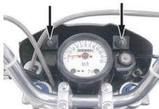
○ タンク左下車体側面のスピードメーター用6極カプラ(黒)を取り外し、エアクリナーボックス固定ボルト2本と、ハンドルロックキーシリンダー後方のコードクランプ固定ボルトを外して下さい。
