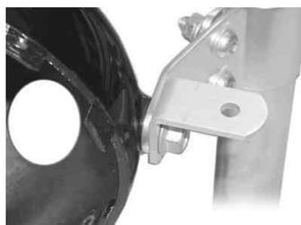
6. ヘッドライトケース及びウインカーステーの位置と角度を調整し、フランジ6角ボルト8MMを締め付けてから、ヘッドライトステーの6角ナット6MMを少しずつ均等に締め付けます。
