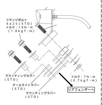
【6.テールライトブラケットCOMP.よりナット、プレーンワッシャ、 【 スプリングワッシャを取り外し、カラーをボルトに通してテールラン 【 プステーにセットします。
