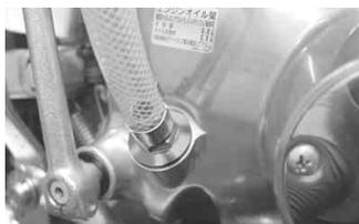
3. シリンダーヘッドよりタベットキャップ(上側)を取り外します。
