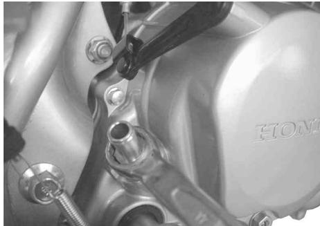
8 . クラッチカバー用ブレードホース を適当な長さに切断し、ブリーザーキャップに差し込み、ホースクランプにて固定します。
