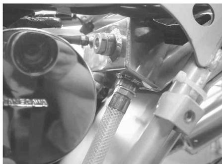
7 . 右クランクケースカバーよりオイルレベルゲージを取り外し、Oリングにエンジンオイルを薄く塗布し、ブリーザーキャップと共にオイル給油口に取り付けます。
