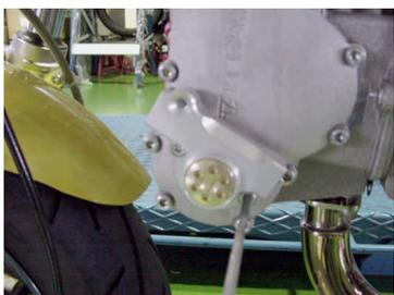
△注意：Oリングを損傷させない事。
