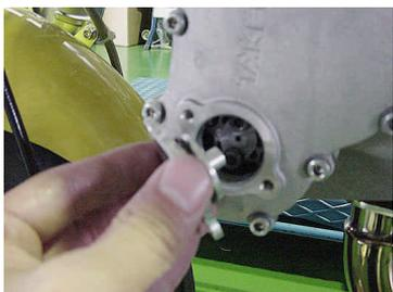
4. ローターギヤの溝をカムギヤを止めているソケットキャップスクリューに合わせながらユニットボディのOリング部にオイルを塗布し、シリンダーヘッドサイドカバーのホールに差し込み、ソケットキャップスクリューM5×10・2本を用いて取り付け、締め付けます。
