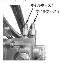
【 6 . オイルホースが他の部品に著しく干渉しない様に取り付けします。 オイルホース1をオイルクーラー下側の取り出し口に、オイルホース2を上側の取り出し口に取り付けます。取り回しが決まれば フィッティングを規定トルクで締め付けます。写真を参考にし、 キット付属のインシュロックタイでホースを固定します。フレーム 等に干渉する部分があればスパイラルチューブ等を使用し、保護して下さい。
