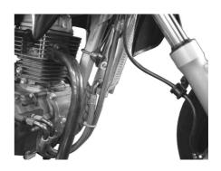
7. エンジンを始動し、各部よりオイル漏れなどの有無を確認して下さい。エンジンを止め、約一分後にクラッチケースカバーのオイルポッドウインドでオイルの量を確認し、少ない場合は必ず補充して下さい。
