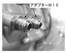
5 . アダプターM 1 0 にオイルホースを仮付けします。乗車状態から見て右側にオイルホース 1 (3 3 0 mm)を左側にオイルホース 2 (5 6 0 mm)を取り付けます。
