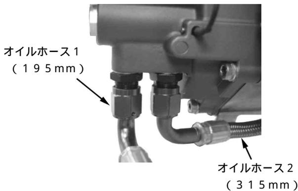
6. スーパークールType A使用の際は、アダプターM12にシーリングワッシャ14mmを通し、オイルクーラー側のシーリングワッシャがオイルクーラーヘッダー(六角部分の凹部)からずれないように取り付けて締め付けます。シーリングワッシャがずれた状態でユニオンボルトを締め付けた場合、オイル漏れの原因になります。アダプターの締め付けはオイルクーラーヘッダーに必ずスパナ等を掛けた状態でアダプターを固定しながら行なって下さい。注意：規定トルクを必ず守って下さい。
