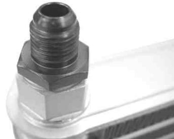
7. オイルホースが他の部分に著しく干渉しない様にオイルクーラーに取り付けます。オイルホースを乗車状態から見て右側のホースをオイルクーラー右側へ、左側のホースをオイルクーラー左側へそれぞれ取り付けます。取り回しが決まればオイルホースフィッティングを規定トルクで締め付けます。フィッティングを締め付ける際、必ずアダプターにスパナをかけた状態で行って下さい。注意：規定トルクを必ず守って下さい。
