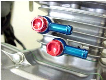
9. オイルホースを適当な寸法に切断し、オイルクーラーのユニオン、シリンダーのバンジョーに差込み、ホースバンドで締め付けます。
