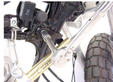
6. オイルクーラーをクーラーステーにブレンワッシャ6mmとボタンヘッドスクリュー6×10で取り付け、規定トルクで締め付けます。
