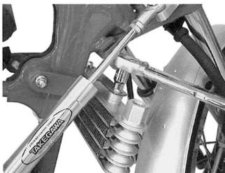
5. オイルの受け皿を用意し、フィルターカバーを取り外します。フィルターカバーを外すとエンジンオイルが出てきますのでご注意ください。
