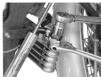
9. フュ - エルタンクを取り付けフュ - エルチューブを接続しフュ - エルコックレバーを取り付けます。左サイドカバーとシートを取り付けます。エンジンオイルを4段 100 cc / 3段 80 cc を補給し、エンジンを始動します。各部からのオイル漏れを点検して下さい。エンジン始動後は、オイルクーラーやクーラーユニット等が高温になりますので十分注意して下さい。
