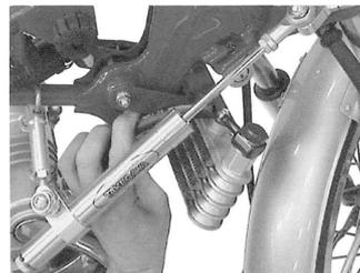
8. オイルクーラーヘッダー (6角部分) に必ずスパナ等を掛けた状態でオイルユニオンを固定しながらユニオンボルトを指定トルクで締め付けます。
