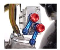
(9) アダプターにシーリングワッシャを通し、オイルクーラーユニット に取り付け、規定トルクで締め付けます。
