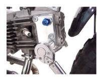
(10) バンジョーに オイルホースを取り付け、そのホースのもう一方を オイルクーラーユニットのアダプターに取り付けます。
