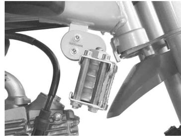
オイルクーラー部分が前からみて水平で、横から見てフロントフェンダー及び車体やエンジンと干渉していない事を確認します。
