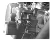
6 . キット付属のオイルホースを写真を参考にし、オイルクーラー側の ユニオン、カバー側のストレートアダプターに差し込みホースバンド で締め付けます。
