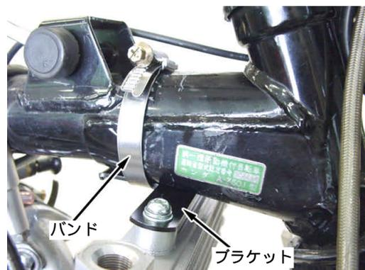
7. オイルクーラーブラケットにオイルクーラーCOMP. をボタンヘッドスクリュー (M6 × 10) 、スプリングワッシャ (6 mm) とブレンワッシャ (6 mm) で取り付けます。(この時、ワイヤーハーネスがオイルクーラーブラケットとオイルクーラーの間を通るようにして下さい。)
