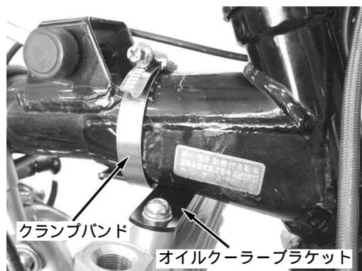
4. オイルクーラーブラケットにオイルクーラーCOMPをボタンヘッドスクリュー6X10、スプリングワッシャ6mmを使い取り付けます。(この時、ワイヤーハーネスがオイルクーラーブラケットとオイルクーラーの間を通るようにして下さい。また、オイルクーラーCOMP部分が前から見て水平で、横から見て垂直になっていることを確認し歪んでいる場合は、オイルクーラー本体を持ってゆっくり動かして水平になる様に修正して下さい。)
