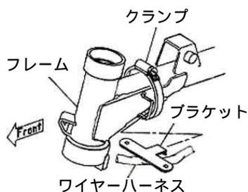
6. オイルクーラーブラケットにオイルクーラーCOMP.をボタンヘッドスクリュー（ $6 \times 10$ ）スプリングワッシャ（ $6 \text{ mm}$ ）とプレーンワッシャ（ $6 \text{ mm}$ ）で取り付け、締め付けます。（この時、ワイヤーハーネスがオイルクーラーブラケットとオイルクーラーの間を通るようにして下さい。）
